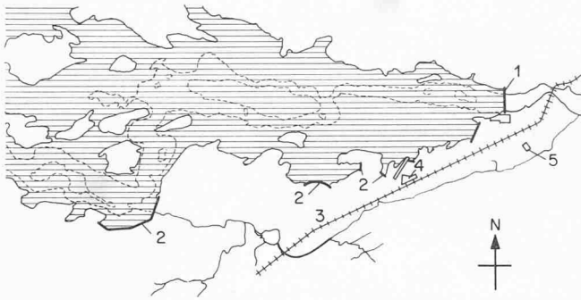
Bild 7. Übersichtsplan der Baustelle für das Kettle Kraftwerk 1 Hauptbauwerk, 2 Seitendämme, 3 Eisenbahn, 4 Siedlung Gallam, 5 Umformer-(Gleichrichter-)Anlage
