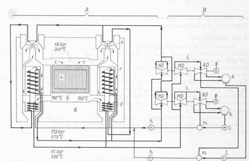
Bild 2. Schema der Helium- und Dampf/Wasserkreisläufe
