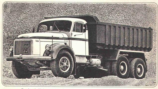
Das ist ein Volvo NB 88 (6x4) mit einem Spezialaufbau\* für 9 m³ Gestein. Auch bei Voll-Last können Sie, ohne den Motor hochzujagen, weich anfahren, denn der Drehmomentwandler verdoppelt die Anfahrkraft.
