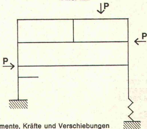
– Das Programm berechnet Momente, Kräfte und Verschiebungen nach der Deformationsmethode
