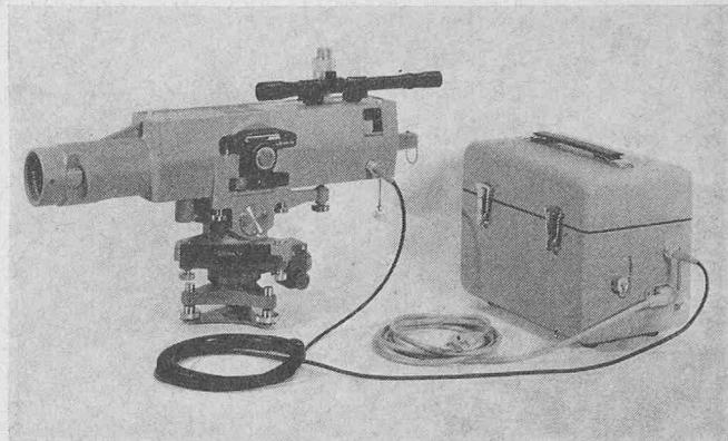
hingewiesen werden, dass das Laserlicht den normalen optischen Gesetzen gehorcht und deshalb durch atmosphärische Bedingungen wie Nebel, starke Luftturbulenz usw. beeinflusst wird.
