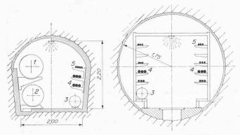
Bild 2. Links Profil des Stollens Lugano-Vedeggio (1965/66); rechts dasjenige des Stollens Crespera-Gemmo (1971). 1, 2 Abwasserrohr-Leitungen, 3 Trinkwasser, 4 Leitungskabel, 5 Meldekabel
