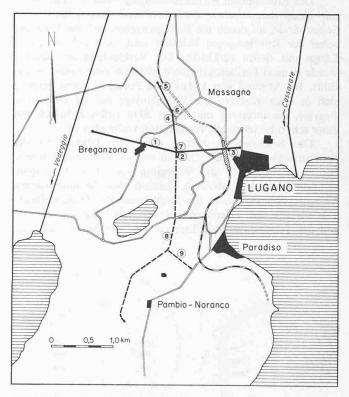
Bild 1. Übersichtsplan über das Stollensystem von Lugano. 1 Stollen Lugano-Vedeggio, 2 Verbindungsschacht zum Unterwerk Gemmo OECL, 3 Kaverne für das Elektrizitätswerk, 4 Stollen Crespera-Gemmo, 5, 7 vertikale Zugangsschächte, 6 neue Telephonzentrale und vertikaler Verbindungsschacht, 8 projektierte Fortsetzung des Stollens Crespera-Gemmo nach Pambio-Noranco, 9 projektiertes Fenster Paradiso
