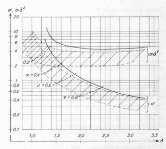
Bild 4. Untere Auftragung: Cordier-Kurve nach [2], umgezeichnet Optimalwerte der Schnellauf-Kennzahl  $\sigma_{\rm opt}$  über die Grössen-Kennzahl  $\delta_{\rm opt}$  im Bereich der Axialventilatoren. Die Bandbreite (schraffiert) ist durch Verschiedenheit der Ausführungsformen und Wirkungsgrad-Definitionen gegeben. Ausgezogene Kurve: Berechnete Kennlinie für frei ausblasende Axialventilatoren (z.T. Laufrad allein). Gestrichelt: Kurven konstanten Nabenverhältnisses v.
