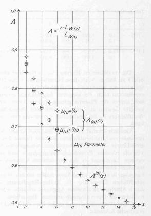
Bild 8. Verhältnis  $\Lambda$  der Wellenleistung  $zL_{W(z)}$  von z Ventilatoren im Tunnel zur Wellenleistung  $L_{W(1)}$  eines einzigen Ventilators bei gleichbleibendem Gesamtschub S in Funktion der Ventilatorzahl z. Die unterste Punkten-Kurve sind eine grobe Näherung, nach [18b], die zwei oberen Punkten-Kurven eine verbesserte Approximation, nach [18a], mit dem Geschwindigkeitsverhältnis  $\mu_{(1)} = u_v/u_{s(1)}$  gleich 1/6 (oben) und 1/10 (unten) als Parameter
