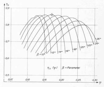
Bild 5. Charakteristiken des Gegenlauf-Ventilators  $2 \times SL$  800/8 G mit im Stillstand verstellbaren Schaufeln, Raddurchmesser 800 mm, Nabenverhältnis 0,5, (Geschenk der Ventilator AG, Stäfa, an das Institut für Aerodynamik – ETHZ), gemessen während Laboratoriumsübungen durch Studierende der Abteilung für Maschineningenieurwesen ETHZ
