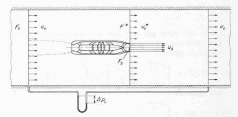
Bild 2. Prinzipskizze für die Wirkungsweise eines Strahlaggregates im Lüftungsabschnitt
