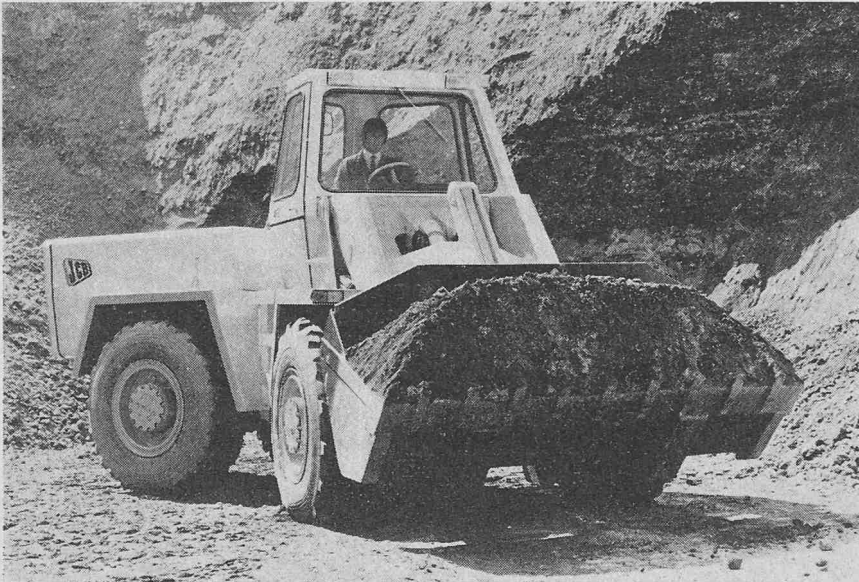
Bild 1. Knicklader JCB 413 (95 DIN-PS, 2500 kg Nutzlast)
