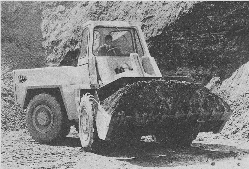
Bild 1. Knicklader JCB 413 (95 DIN-PS, 2500 kg Nutzlast)
