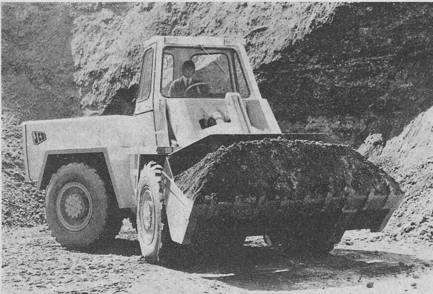
Bild 1. Knicklader JCB 413 (95 DIN-PS, 2500 kg Nutzlast)
