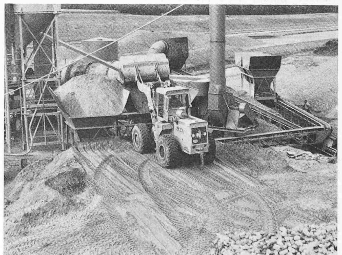
Bild 2. Dieser knickgelenkte Schaufellader Clark Michigan Modell 75 beschickt Doppelsilos in einer Asphaltmischanlage mit einer Produktionskapazität von 160 t/h
