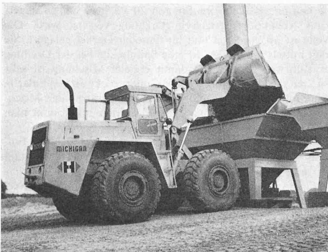
Bild 1. Mit einem schnellen Schaufellader können mehrere Silos einer durchschnittlich grossen Anlage beschickt werden. Dieser Clark Michigan versorgt die Auffangsilos einer Asphaltmischanlage mit 230 t/h Leistung
