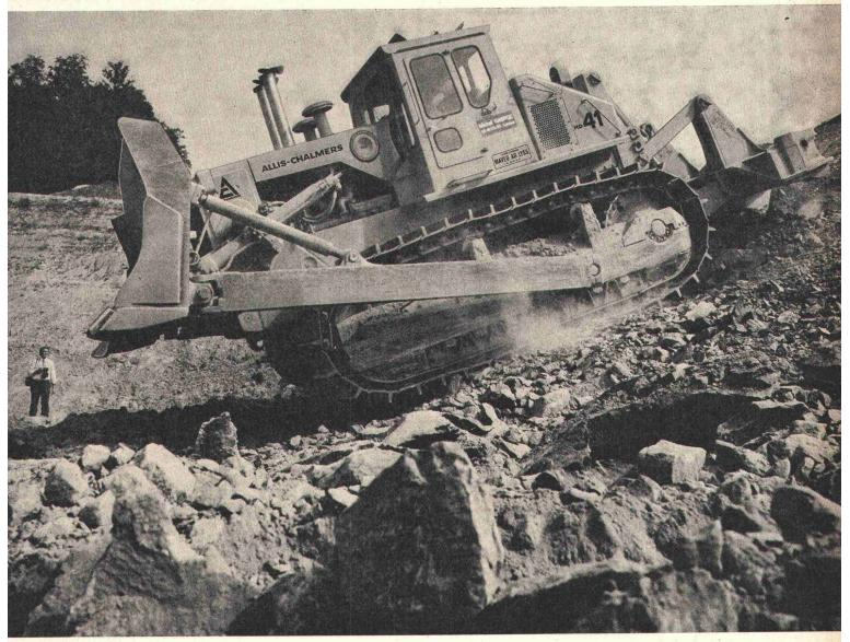
ALLIS-CHALMERS HD 41: Der grösste Bulldozer der Welt in äusserst hartem Einsatz (Molasse) in der Grube der BTR Matériaux SA in Crissier. Zwölf-Zylinder-Dieselmotor; Dauerleistung 585 PS; 67 Tonnen Einsatzgewicht inkl. Bulldozerblatt (Breite 5,18 m, Höhe 2,16 m) und hydraulisch gesteuertem Aufreisser mit einer beachtlichen Eindringtiefe von 1,07 m.
