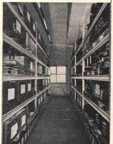
Paletten-Rollgestellanlage mit 14 Doppel-Fahrgestellen. Tragkraft 60 t je Gestell. Einzel-Chassisantrieb mit direkt angeflanschem Stirnrad-Bremsgetriebemotor, über Fusschalter steuerbar.
