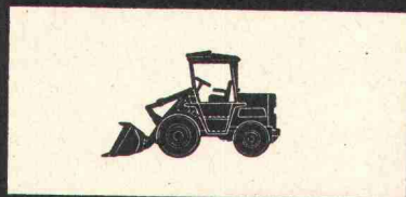
Radlader Europ L 500 Motor: 35 SAE-PS Schaufeln: 0,4–0,85 m 3 Gewicht: 4350 kg
