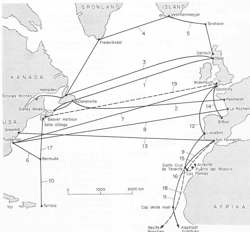
Übersicht über die im Nordatlantik ausgelegten oder im Bau befindlichen Seekabel. Die Zahlen in Klammern nach dem Fertigstellungsjahr geben die Anzahl der Sprachkanäle an
