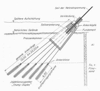
Bild 1. Schnitt durch eine Seilabspannung mit Injektionszuganker «Stump-Duplex»
