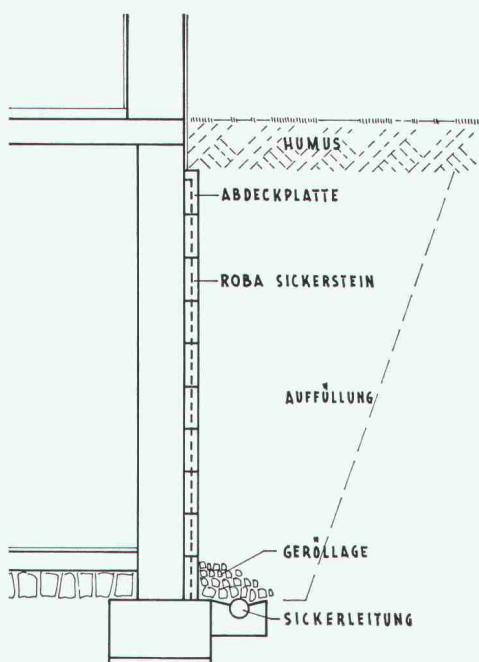
Typen: Sickerstein und Abdeckplatte
