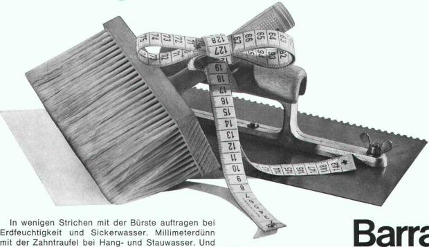
In wenigen Strichen mit der Bürste auftragen bei Erdfeuchtigkeit und Sickerwasser. Millimeterdünn mit der Zahntraufel bei Hang- und Stauwasser. Und etwas dicker bei Berg- und Grundwasser. Nach Mass in Schichten von nur 2 mm, 3 mm und 5 mm, um sicher und dauerhaft abzudichten.
