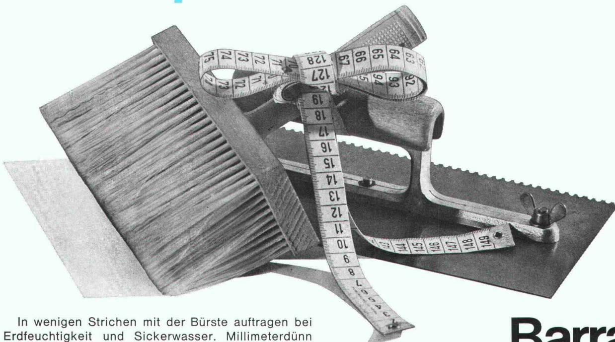
In wenigen Strichen mit der Bürste auftragen bei Erdfeuchtigkeit und Sickerwasser. Millimeterdünn mit der Zahntraufel bei Hang- und Stauwasser. Und etwas dicker bei Berg- und Grundwasser. Nach Mass in Schichten von nur 2 mm, 3 mm und 5 mm, um sicher und dauerhaft abzudichten.
