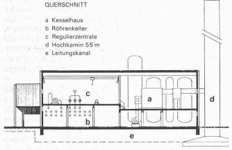
Bild 2. Fernheizwerk Hagenholz, Querschnitt
