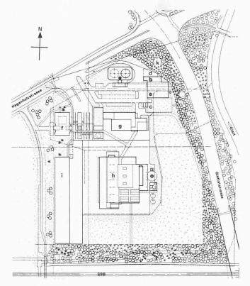
Bild 1. Lageplan des Fernheizwerkes Hagenholz und der Kehricht-Verbrennungsanstalt (KVA) 2, Massstab 1:4000.
