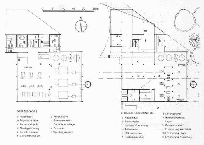
Bild 3 oben. Fernheizwerk Hagenholz, Grundrisse, links Obergeschoss, rechts Erdgeschoss, Massstab 1:500
