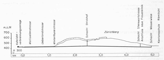
Bild 1. Längenprofil des Kanals und des Stollens für die Fernheizung
