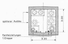
Bild 6. Querschnitt durch den Kanal
