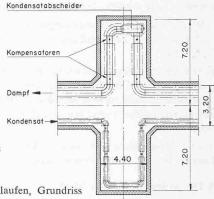
Bild 8 (rechts). Wärmeausdehnungsschlaufen, Grundriss
