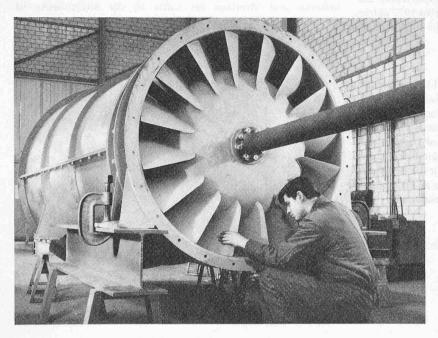
Bild 3b. Verstellbarer Vordrall-Leitapparat zur kontinuierlichen Regelung von Volumen und Druck Druck (Werkphotos Luwa AG Zürich)
