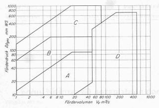
Bild 2. Annähernde Betriebsbereiche verschiedener Axialventilatoren
