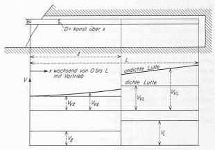
Bild 5. Sprunghafte Erhöhung der Luftmenge nach Erreichen der Vortriebslänge l
