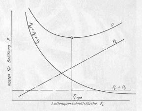
Bild 1. Prinzipieller Verlauf der Einzelkosten für die Belüftung eines Tunnels in Abhängigkeit der Luttenquerschnittsfläche
