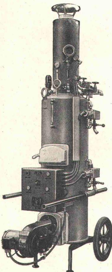
bietet als Vollautomat entscheidende Vorteile. Grosse Zeitersparnis: innert weniger Minuten genügend Dampfdruck zur Aufwärmung von Kies und Sand. Silobeheizung auch während der Nachtstunden. Solide Bauart, geringes Gewicht. Für Oelbetrieb (Automat) wie für feste Brennstoffe lieferbar.
