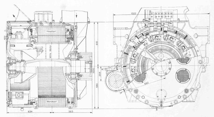
Bild 36. Längs- und Querschnitt durch den Fahrmotor
