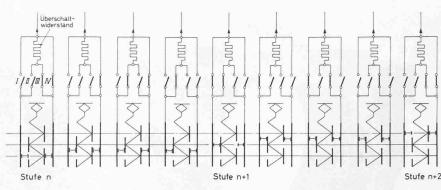
Bild 32. Schaltfolge der Lastschalter und der Wählerkontakte beim Stufenschalter Typ NO 32/4
