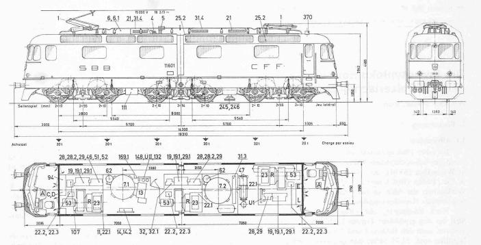
Bild 3. Typenbild der Re 6/6 11 601/11 602 mit Anordnung der elektrischen Ausrüstung
