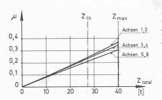
Bild 21. Geforderter Adhäsionskoeffizient  $\mu$  jeder Achse in Funktion der Zugkraft  $Z_{\rm tot}$  (Lokomotive 11603)
