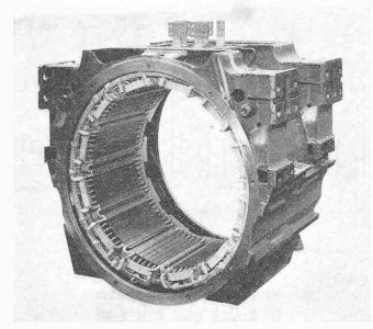
Bild 34. Fahrmotor - Stator
