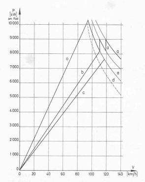
Bild 5. Leistungskennlinien für 15 kV Fahrleitungsspannung (Leistung *P* am Rad in Abhängigkeit von der Geschwindigkeit *V*):
