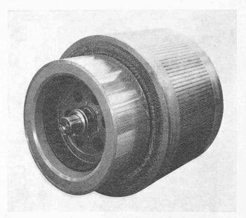
Bild 35. Fahrmotor - Rotor
