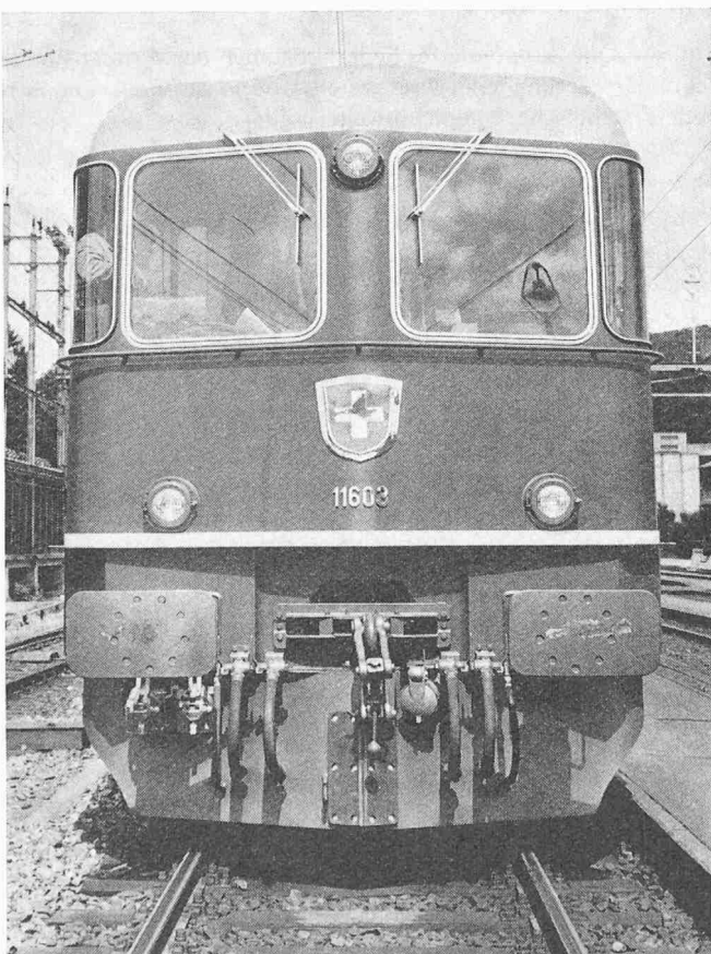
Bild 22. Stirnansicht der Lokomotive Re 6/6. Von links nach rechts befinden sich am Stossbalken: Kupplungsdose für Zugheizung 1000 V, Kupplungsdose für Zugheizung 3000 V, Schläuche für Rangierbremse, Speiseleitung und automatische Bremse, Kupplungsdose für Vielfachsteuerung, Schläuche für automatische Bremse, Speiseleitung und Rangierbremse
