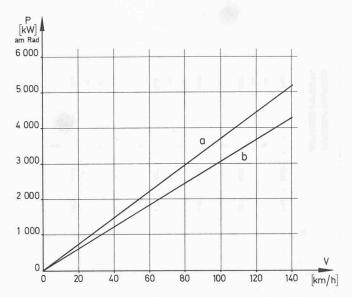
Bild 29. Leistungskennlinien für Rekuperation (bei 15 kV Fahrdrahtspannung)
