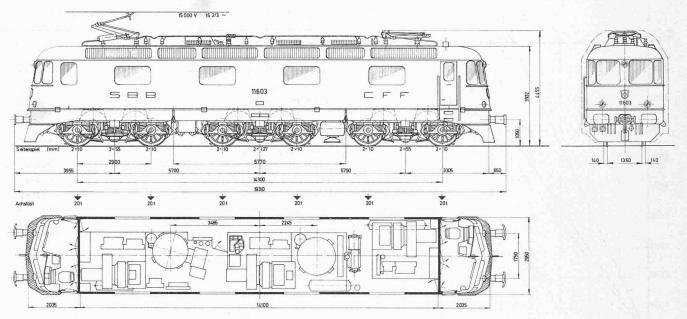
Bild 4. Typenbild der Lokomotive Re 6/6 11 603
