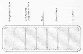
Bild 38. Schnitt durch eine Hauptpolspule (Erregerwicklung) des Fahrmotors
