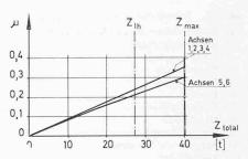
Bild 17. Geforderter Adhäsionskoeffizient  $\mu$  jeder Achse in Funktion der Zugkraft  $Z_{\rm tot}$  (Lokomotiven 11601, 11602 und 11604)
