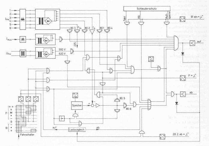
Bild 42. Prinzipschema der Stufenschaltersteuerung
