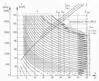
Bild 26. Zugkraftkennlinien der Re6/6 bei 15 kV Fahrdrahtspannung. Der ausgezogene Linienzug zeigt den Zugkraftverlauf bei einer Anfahrt auf Stellung ++ des Fahrschalters
