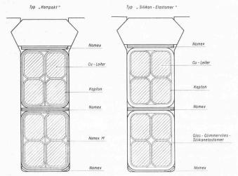
Bild 37. Schnitt durch eine Ankernute des Fahrmotors
