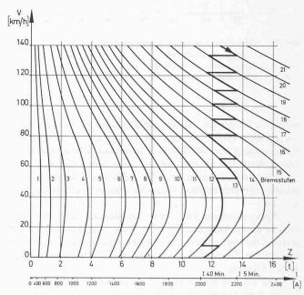
Bild 28. Bremskraftkennlinien der Re6/6 bei 15 kV am Fahrdraht. Der ausgezogene Linienzug zeigt den Bremskraftverlauf bei einer Bremsung mit maximalem Bremsstrom (Fahrschalter auf Stellung Bremsen +)
