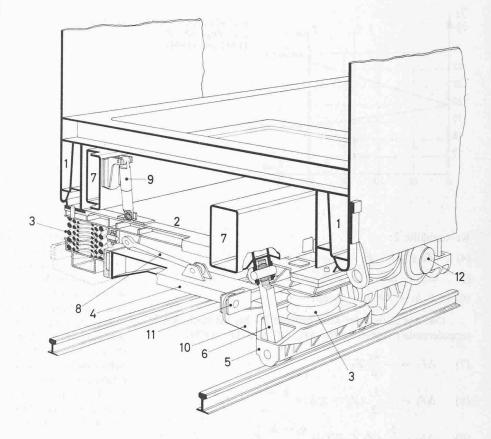
Kasten erhält bei Ablieferung ebenfalls Schraubenfedern. Pro Drehgestellseite befinden sich nebeneinander zwei gleiche Federgruppen; die Federkonstante pro Paket ist bei den äusseren Drehgestellen bedeutend grösser als beim mittleren Drehgestell. Bei der Lokomotive 11 604 sind Luftfedern eingebaut. Der normale Betriebsdruck der Federbälge erreicht etwa 5,2 atü, die mittlere Federkonstante im Betriebspunkt variiert je nach Grösse des Zusatzvolumens.
