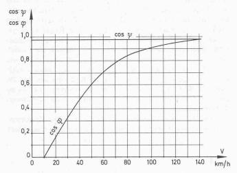
Bild 30. Verlauf der Leistungsfaktoren im Bremsbetrieb
