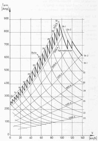
Bild 24. Verlauf des Primärstromes  $I_{\rm prim}$  in Funktion der Geschwindigkeit V (für Zugheizstrom  $I_Z=0$ ) bei 15 kV Fahrleitungsspannung. Der ausgezogene Linienzug zeigt den Verlauf des Primärstroms bei einer Anfahrt auf Stellung ++ des Fahrschalters
