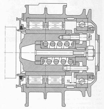
Bild 12. Achslager mit Seitenfederung
