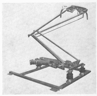
Bild 23. Stromabnehmer Bauart BBC, Typ ESa 06-2500
