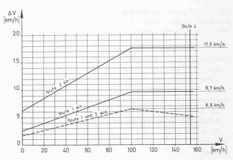
Bild 44. Charakteristik der Schleuderschutzeinrichtung, V Fahrzeugeschwindigkeit,  $\Delta V$  Relativgeschwindigkeit zwischen Rad und Schiene
