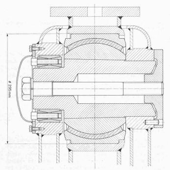
Bild 9. Schnitt durch das Kastengelenk der Lokomotiven 11 601 und 11 602
