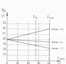
Bild 20. Achslasten F/2 in Funktion der Zugkraft Ztot (Lokomotive 11603)
