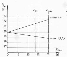
Bild 16 (links). Achslasten F/2 in Funktion der Zugkraft Z<sub>tot</sub> (Lokomotiven 11601, 11602 und 11604)
