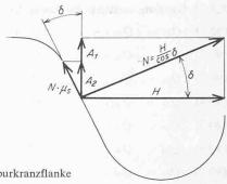
Bild 6. Kräfte an der Spurkranzflanke
