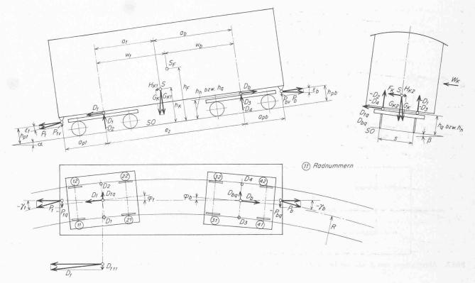
Bild 1. Abmessungen und Kräfte am Drehgestellfahrzeug
