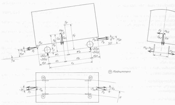
Bild 3. Abmessungen und Kräfte am zweiachsigen Fahrzeug
