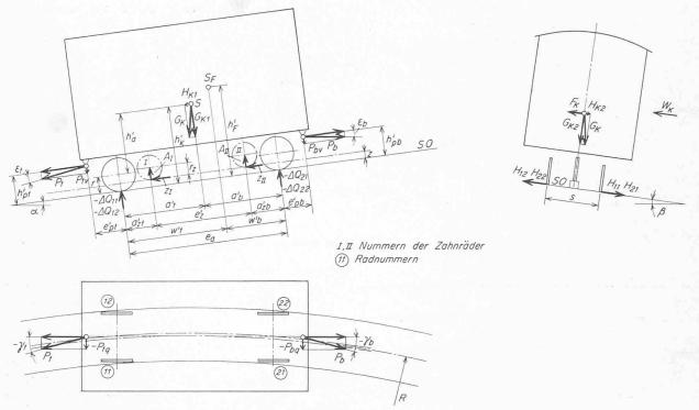
Bild 5. Abmessungen und Kräfte am zweiachsigen Zahnradbahnfahrzeug
