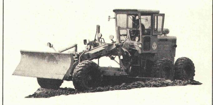
11 700 kg, Leistung 135 PS (DIN), Lastschaltgetriebe und Orbitrollenkung - auf Wunsch automat. Schar-
