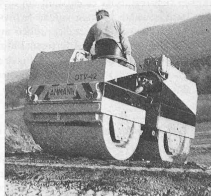
Bild 3. Doppel-Tandem Vibrationswalze DTV-42, Gewicht 4400 kg, Walzendurchmesser 920 mm, Walzenbreite 1230 mm, Mittelpunktklenkung-Doppelantrieb
