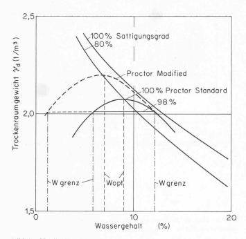
Bild 4. Verdichtungsversuch
