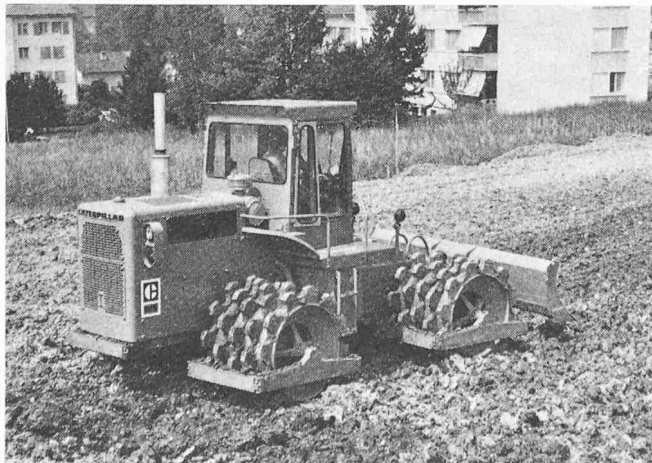
Bild 5. Selbstfahrender Caterpillar-Tamping-Verdichter 815. Einsatzgewicht 18,1 t
