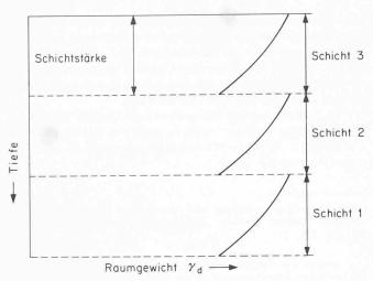
Bild 7. Tiefenwirkung von Verdichtungsgeräten
