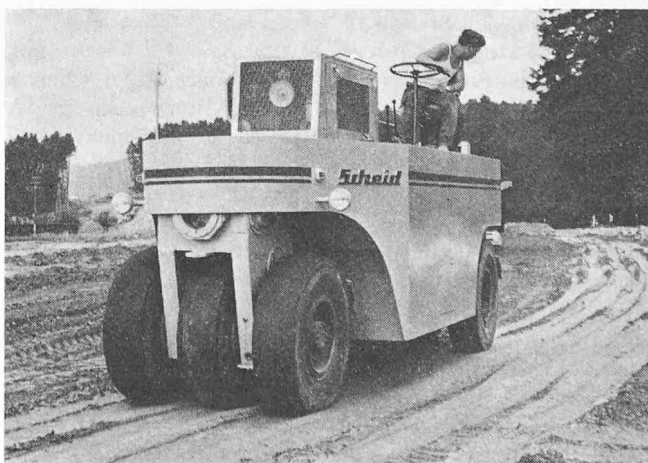
Bild 6. Scheid-Gummiradwalze mit wenigen, aber grossen und breiten Reifen
