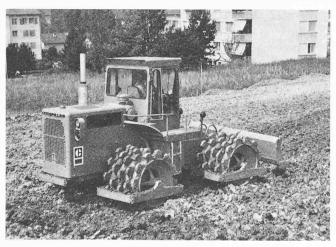
Bild 6. Scheid-Gummiradwalze mit wenigen, aber grossen und breiten Reifen
