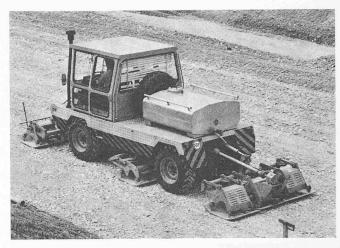
Bild 9. BV-9: Boschung-Verdichter, drei Reihen zu je drei Platten
