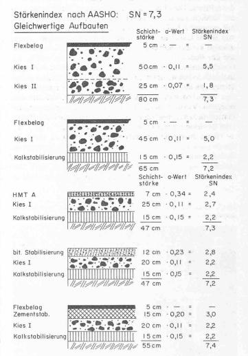
Bild 3. Beispiel einer Bemessung. Verbindungsstrasse,  $100\,000$  Normallasten  $8,2\,t$  während der angenommenen Lebensdauer von 30 bis 50 Jahren, Untergrundtragfähigkeit CBR =  $2\,\%$ , Regionalfaktor  $1,5\,[1]$
