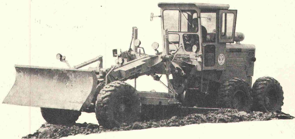
Mark IV: Einsatzgewicht 11700 kg, Leistung 135 PS (DIN), Lastschaltgetriebe und Orbitrollenlenkung – auf Wunsch automat. Schar-
