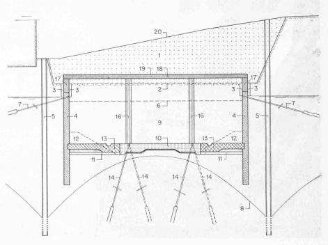
Bild 2. Schnitt durch das Bauwerk 1:300 mit Angabe des Bauvorganges. Die Nummern beziehen sich auf die verschiedenen notwendigen Einzelmassnahmen und sind im Text erklärt
