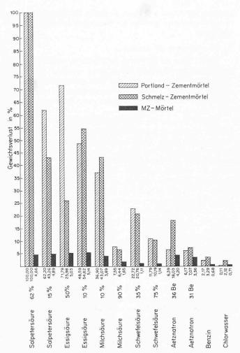
Bild 2. Abra-chemische Resistenz von Zement- und Kunstharzmörteln
