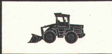
Radlader Europ L 800 Motor: 80 SAE-PS Schaufeln: 0,8–1,3 m 3 Gewicht: 5800 kg
