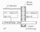
Bild 2a. Keine elektrische Verbindung der Betonarmierung mit der stählernen Rohrleitung. Keine positive Potentialverschiebung der Rohrleitung, keine Korrosionsgefahr durch Elementbildung
