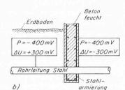
Bild 2b. Elektrische Verbindung der Betonarmierung mit der Rohrleitung. Rohroberfläche ≅ Armierungsoberfläche. Positive Potentialverschiebung + 300 mV an der Rohrleitung. Korrosionsgefahr durch Elementbildung
