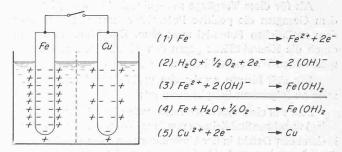
Bild 1. Beispiel des elektrochemischen Umsatzes bei der Korrosion von Stahl
