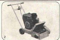
1 Hochleistungs-Schleifmaschine für Beton und Terrazzo (z. B. zum Staubfreimachen von Betonböden). Die Maschine mit der grossen Leistung.
