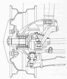
Lagereinheit in Form zweireihiger Schrägkugellager als Vorderradlager in einem Personenwagen
