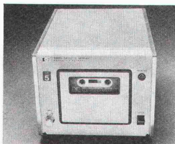
Magnetbandkassette Modell 9865A. Mit diesem preiswerten Massenspeicher lassen sich bis zu 48000 Programmschritte oder 6000 Daten verarbeiten.
