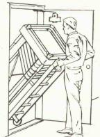
AIR LIFT ist unabhängig vom Stromnetz. Eigener CO<sub>2</sub>- oder Stickstoffantrieb treibt die stabile Aluminium-Plattform auf drei teleskopischen Stützpfeilern in Sekundenschnelle in die gewünschte Arbeitshöhe (bis 12,5 m).
