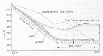
Bild 9. Geologischer Schnitt durch den Westteil des Rutsches. Die gestrichelte Linie bezeichnet eine Störung, wie sie für die Erklärung des Bergsturzes angenommen wird (Nach [2] S. 15)
