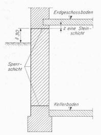
Bild 1. Sperrschichten bei unterkekellerten Bauten nach Karl Lufsky, Berlin)
