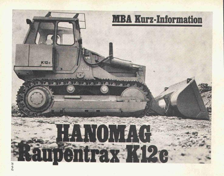
Der kraftvolle Raupenlader mit 140 PS und 1,6 m³ Schaufelinhalt. Bewährtes verbindet sich mit technischem Fortschritt zu einer neuen Gesamtkonzeption. Ergebnis: eine ausgereifte Maschine – zuverlässig, wirtschaftlich und jeder Aufgabe gewachsen.
