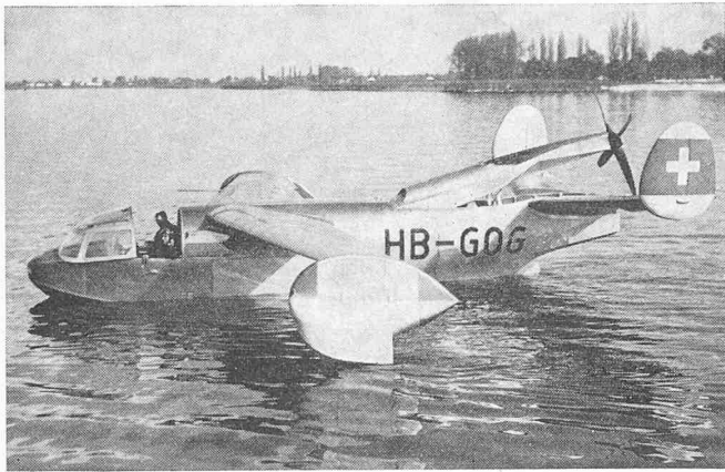
Das amphibische Flugzeug Dornier Do 212 mit schwenkbarer Luftschraube hinter dem Leitwerk. Leistung 450 PS, Gewicht 2,3 t (Entwicklung 1938 bis 1941) (Werkphoto FFA)
