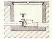
Rückstaudoppelverschluss TRIPLEX für durchgehende Leitungen
