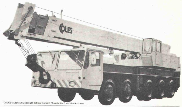
Dieselhydraulische COLES-Mobil- und Autokrane mit Teleskopausleger:
