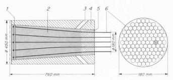
Bild 4. Schematisch dargestellter Aufbau einer Hi-Am-Verankerung am Beispiel eines Längsschnittes durch einen Normalseilkopf mit 109 siebendrähtigen Litzen Durchmesser 0,6"
