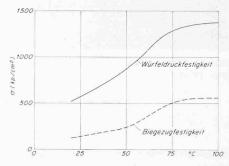
Bild 20. 7-Tage-Festigkeit der Kugelvergussmasse in Abhängigkeit der Maximaltemperatur während des Aushärtevorganges; Mittelwerte gemessen an Prismen  $4\times4\times16~\mathrm{cm}$
