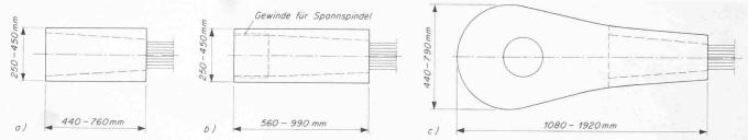
Bild 5. Umrisse der für die Hi-Am-Verankerung der Haupttragseile verwendeten Seilkopftypen mit Minimal- und Maximalabmessungen. a) Normalseilkopf als feste Verankerung, b) Gewindeseilkopf als spannbare Verankerung, c) Gabelseilkopf als gelenkige Verankerung
