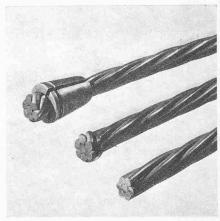
Bild 10. Litzen mit aufgestauchten BBRV-Köpfen als Einpresshilfe und Sicherung einer festen Keilverankerung
