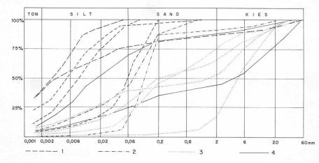
Bild 1. Kornverteilung einiger typischer, eiszeitlicher Seeablagerungen. Man beachte die Knikkung vieler Summationskurven, welche auf gleichzeitige Materialzufuhr aus verschiedenen Sedimentationsquellen zurückzuführen ist.
