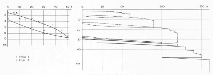
Bild 7. Lastsetzungsdiagramme der Probepfahlversuche; Holzpfähle (links), Bohrpfahl (rechts)
