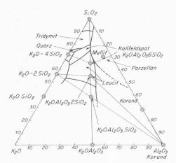
Bild 1. Porzellan im System K<sub>2</sub>O-Al<sub>2</sub>O<sub>3</sub>-SiO<sub>2</sub>
