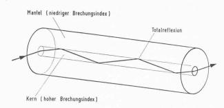
Bild 1. Führung eines Lichtstrahls in einer Glasfaser
