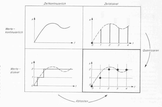
Bild 1. Der Übergang vom analogen Signal (z. B. Mi-krophonspannung) zum digitalen Signal (z. B. PCM) erfolgt über zwei Schritte: Abtasten + Quantisieren. Auch die beiden Zwischenstufen (nur Abtasten oder nur Quantisieren) sind für gewisse Anwendungen von Bedeutung
