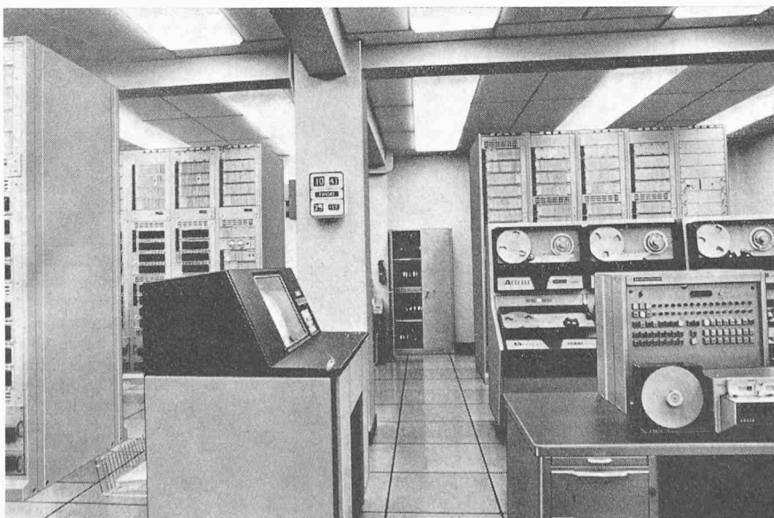
Bild 5. Programmgesteuerte Computeranlage zur Steuerung der Vermittlung von PCM-Signalen (System Dataflex 200 von Hasler AG, Bern). Solche Anlagen verfügen über ein wirkungsvolles Überwachungssystem. Bis ungefähr 200 000 Teilnehmer können von einer Anlage bedient werden. Im System IFS-1 kann zudem jeder Teilnehmer gleichwertig von 2 bis 4 dezentralisiert aufgestellten Anlagen bedient werden (katastrophensicher). Die Speicherkapazitäten liegen in der Grössenordnung von 10 Mio bits pro Anlage
