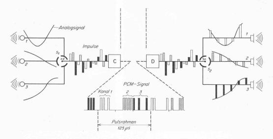
Rild 4 Puls-Code-Modulation (PCM) mit Multiplexie-Im Beispiel werden rung: die Abtastimpulse von drei sendenden Telephonleitunzeitlich verschachtelt gen und dann in einen einheitlichen binären Impulszug umgeformt. Empfangsseitig erfolgt zuerst die weise Umsetzung in Abtastwerte und dann deren Verteilung auf die drei empfangenden Telephonleitungen
