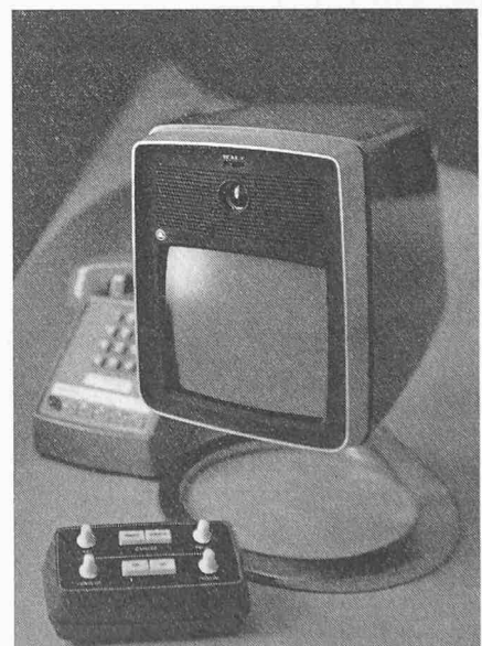
Bild 6. Bildtelephon («Picturephone» von Bell Laboratories). Anschluss über drei Telephonaderpaare (je eines für jede Bildrichtung, eines für Telephon und Wahl). Bildhöhe 13 cm, Auflösung 255 Zeilen, schwarzweiss
