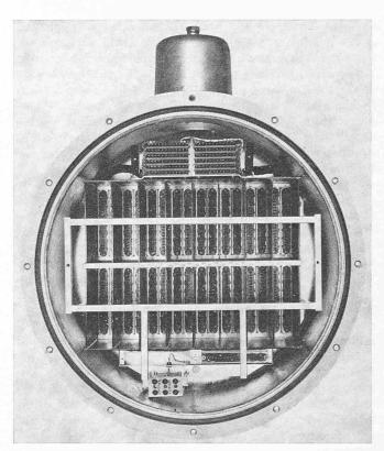
Bild 3. Regenerationsverstärker für PCM-Leitungen (etwa alle 2 km in die Erde versenkt). Über  $2\times 16$  gewöhnliche symmetrische Telephonaderpaare können damit in jeder Richtung 480 Sprechkanäle in PCM-Form übertragen werden
