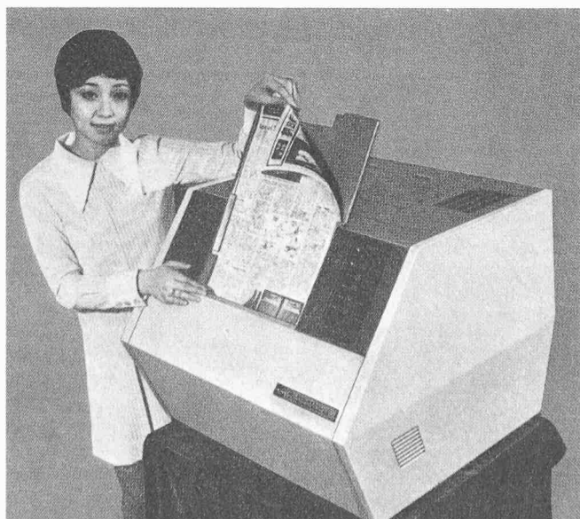
Bild 7. Heimzeitungs-Empfänger (Toshiba, Japan). Als «Homefax»-System am TV-Empfänger anschliessbar: Übertragung der Zeitung in den Bildlücken oder Sendepausen. Das abgebildete Modell «druckt» eine Zeitungsseite doppelseitig in 5 min 40 s (Auflösung 8 Linien/mm) bei einer Bandbreite von 240 kHz
