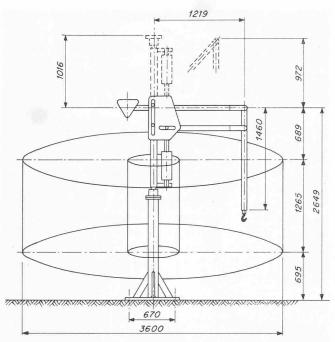
Bild 2. Massskizze und Aktionsbereich des Normalgerätes
