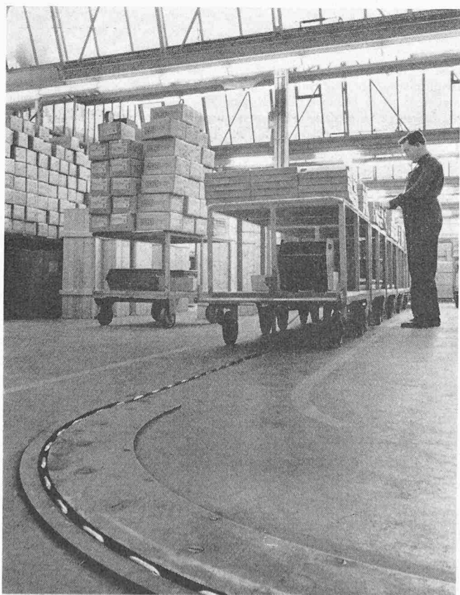
Bild 9. Mit einer bodenversenkten Förderkette werden die Sammelwagen des Lagers mit der Fertigung oder dem Versand verbunden. Mit Stift bekommen sie einen Zielsteuerungsbefehl, um an dem gewünschten Ort ausgeschleust zu werden
