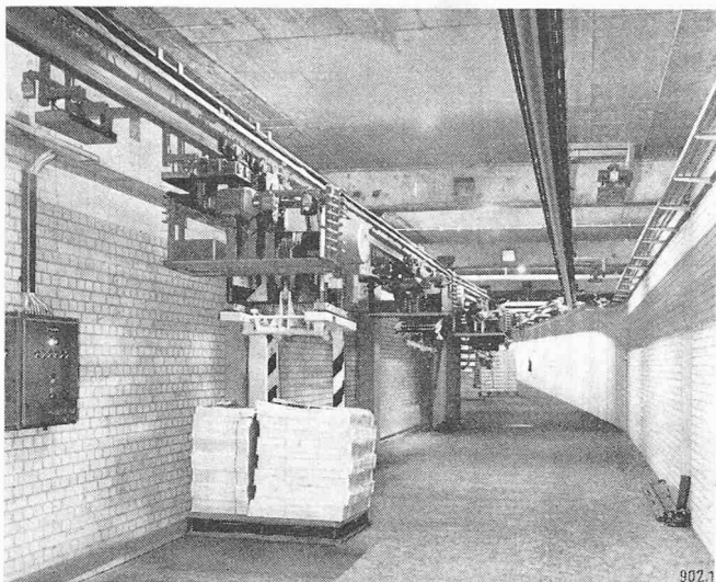
Bild 8. Die Verbindung vom Lager zur Fertigung wird durch eine automatisch gesteuerte Einschienenbahn wahrgenommen, die volle Paletten, Walzen und Papierrollen befördert
