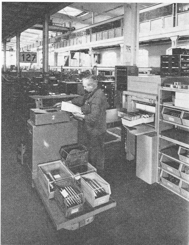
Bild 10. Die Verbindung von Fertigung, Kontrolle und Lager wird durch einen selbststeuernden Elektro-Plattformhubwagen vorgenommen, der seinen Weg an einer bodenversenkten Leitlinie findet und automatisch am Zielort aussteuert
