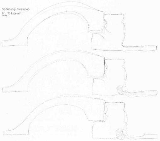
Bild 13. Randelementspannungen in Meridianrichtung (kp/mm²)
