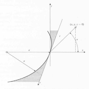
Bild 3. Flache, scharfkantige, elliptische Diskontinuität zum Rissmodell der linear elastischen Bruchmechanik nach *Griffith-Orowan-Irwin*
