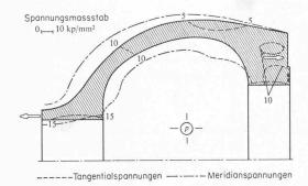
Bild 16. Spannungsverlauf nach Zugspannungsklassen in einem Reaktorhauptkühlmittel-Pumpengehäuse
