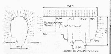
Bild 1. Quer- und Längsschnitt durch die Maschinenkaverne mit schematischer Anordnung der Felsanker. Messquerschnitte MQ 1 bis MQ 4
