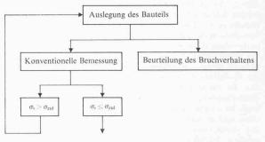
Bild 1. Zweigleisiges Vorgehen zum Bemessen und zum parallelen Beurteilen des Bruchverhaltens. Ferritische Baustähle weisen in der Regel über rund 100°C im Anlieferungszustand eine hinreichende Verformbarkeit zur Vermeidung des spröden Bruches auf [1]
