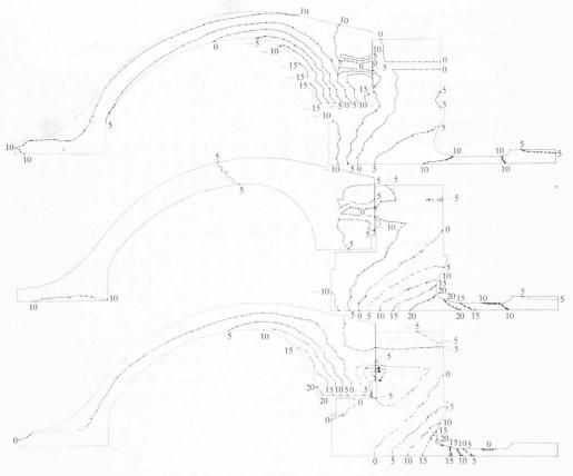
Bild 12. Linien konstanter Umfangsspannungen für drei Betriebszustände
