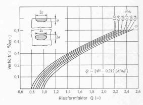
Bild 17. Formfaktor gemäss der linearelastischen Bruchmechanik [2]
