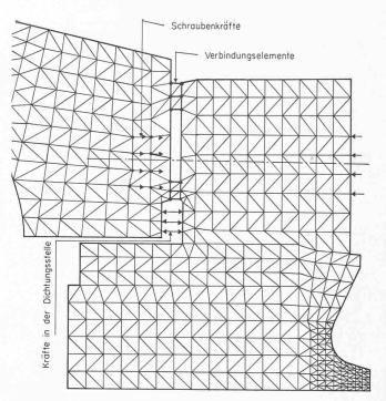
Bild 10. Anordnung der Verbindungselemente in der Trennfläche zwischen Gehäuse und Deckel
