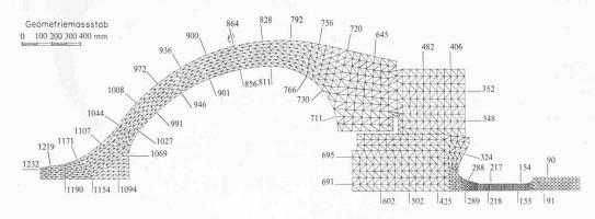
Bild 9. Elementeinteilung für Spannungsberechnung
