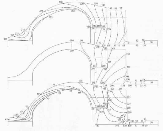
Bild 8. Berechnete Isothermenverläufe für drei Betriebszustände
