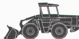
Radlader Europ L 2000 Motor: 215 SAE-PS Schaufeln: 2,0–3,8 m 3 Gewicht: 14100 kg
