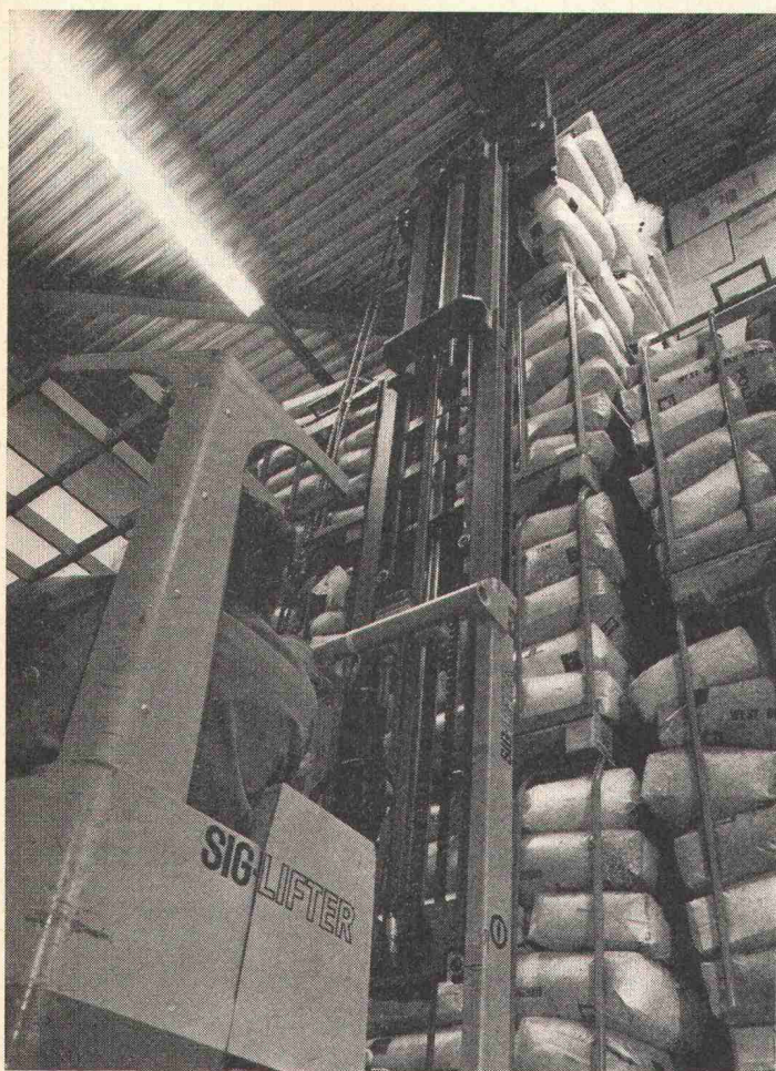
Elektro-Schubmaststapler «SIG-Lifter» mit Triplex-Hubmast für 6,2 m Hubhöhe
