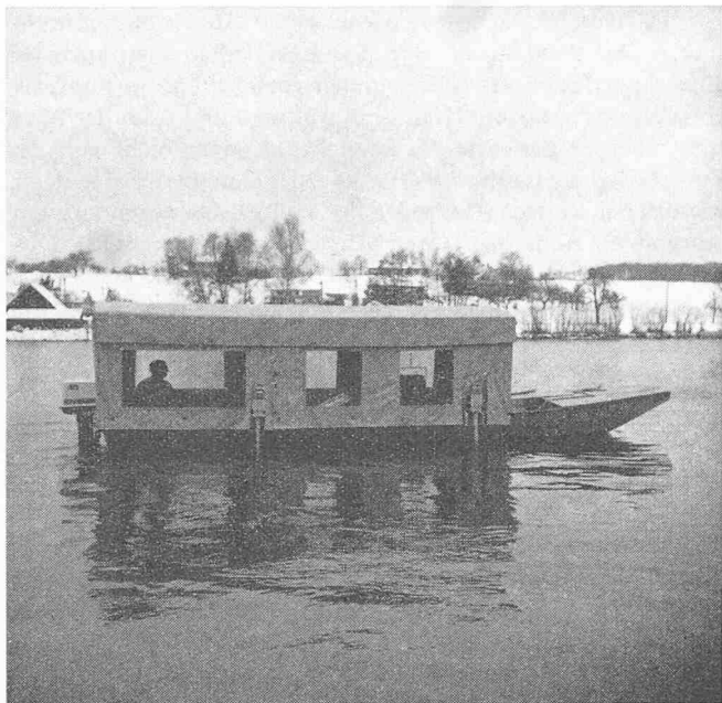
Bild 3. Ansicht des Mess-Schiffes. Man erkennt hinten den Aussenbordmotor von 45 PS und die beiden elektrischen Querantriebe
