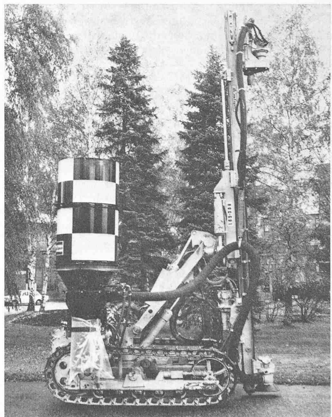
Bild 1. Saugvorrichtung DCE 90. Das Bohrgut, welches vom Bohrloch weggeblasen wird, wird angesaugt (A). Die Saugvorrichtung kommt mit dem Fels nicht in Berührung. Druckluft wird durch den Schlauch B geliefert. Der Ansaugapparat C hält das aufwärtsfliegende Bohrgut auf und verhindert dessen Eindringen in den freien Durchgang des Bohrstahls. Das Bohrgut wird durch einen Schlauch D in die Zyklo-Filtereinheit befördert.
