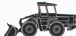
Radlader Europ L 2000 Motor: 215 SAE-PS Schaufeln: 2,0–3,8 m 3 Gewicht: 14100 kg
